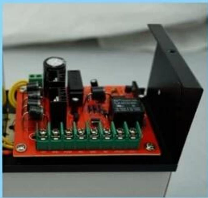
该电源为门禁系统专用，输入电压为AC220V，输出电压为DC12V，最大负载为30VA。内部采用JSJ 5737变压器，安全可靠。
