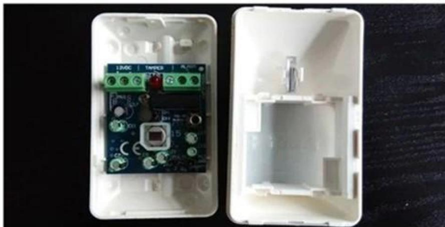
**El sensor del pir del movimiento mini es el sensor del pir detector atado con alambre para el sistema de alarma.**
