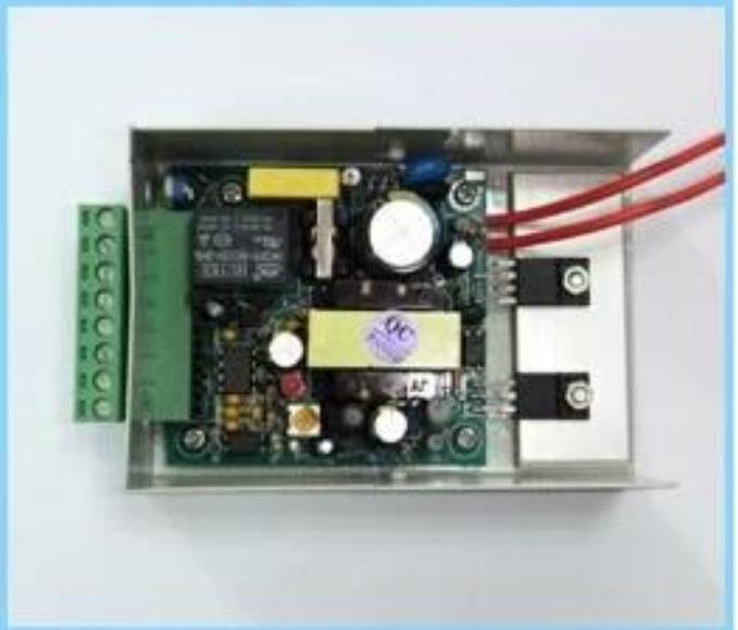
**L'interrupteur d'alimentation avec sortie 12v 3a entrée dc 110V-240V AC et utilisé avec le système de contrôle d'accès.**
