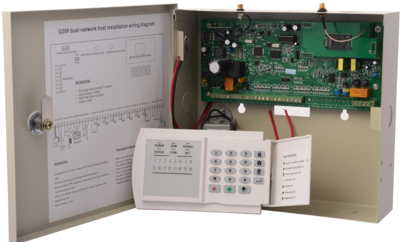
1. Communication numérique haute vitesse, compatible ADEMCO4 + 2, protocole de communication numérique CID; Envoyer le signal d'alarme au centre d'alarme.
