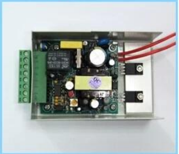
Импульсный блок питания с выходным 12v 3a вход постоянного тока 110В-240В переменного тока и
