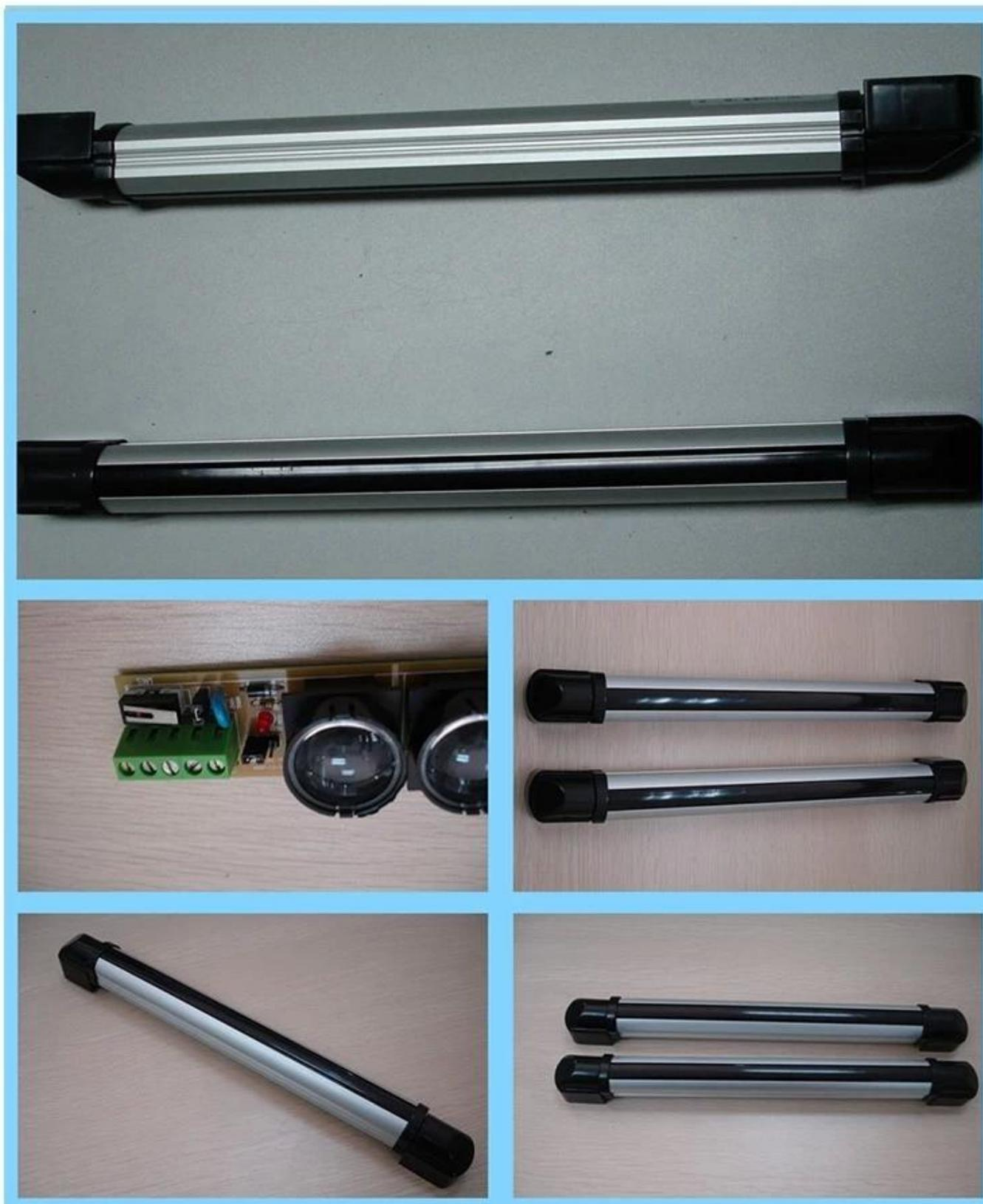
Движение Детектор занавеса двойной инфракрасный луч используется с окном, дверью с системой сигнализации. Датчик света, как датчика работы лазерного забора.
